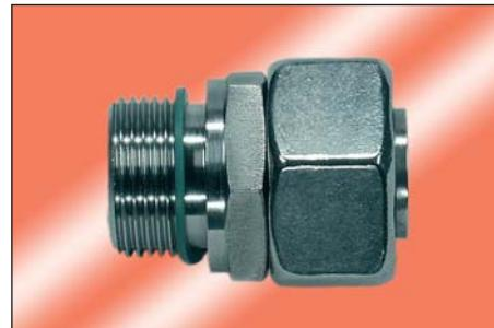
Anschluss D1 ist vormontiert. Die Fertigmontage erfolgt im Stutzen mit ca. 1/2 Umdrehung der Überwurfmutter über den Punkt des deutlich fühlbaren Kraftanstieges.
