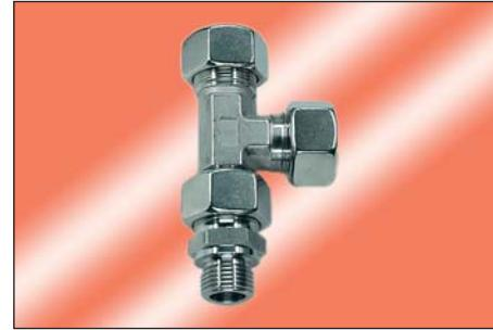
Der Anschluss ist vormontiert. Die Fertigmontage erfolgt im Stutzen mit ca. 1/2 Umdrehung der Überwurfmutter über den Punkt des deutlich spürbaren Kraftanstieges.
