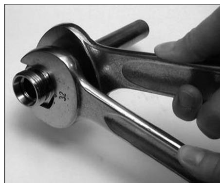
3. Überwurfmutter so weit als möglich von Hand auf den Vormontagestutzen schrauben. Gleichzeitig das Rohr gegen den Anschlag drücken. Sobald der Schneidring das Rohr erfasst hat, wird ein deutlicher Drehmomentanstieg spürbar. Ein Markierungszeichen an der Überwurfmutter erleichtert die Beobachtung der erforderlichen Umdrehungen. Überwurfmutter mit Schlüssel ca. 1 1/4 Umdrehung anziehen. Achtung: Das Rohr darf nicht mitdrehen!
