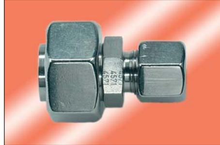
Anschluss D1 ist vormontiert. Die Fertigmontage erfolgt im Stutzen mit ca. 1/2 Umdrehung der Überwurfmutter über den Punkt des deutlich spürbaren Kraftanstieges.
