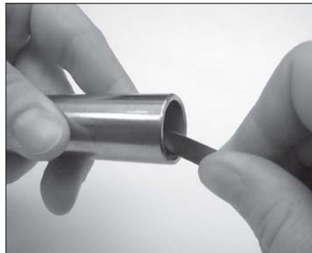
3. Bei Rohrbögen ist die Mindesthöhe des geraden Rohrendes bis Biegeradius zu beachten. Sie muss mind. der 2-fachen Höhe der Überwurfmutter entsprechen.
